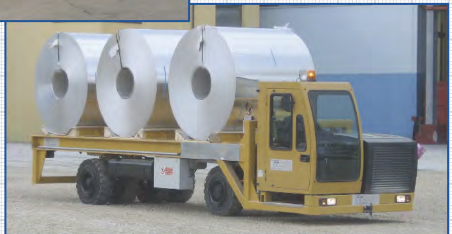
Veicolo Speciale per trasporto coil in operazione.
