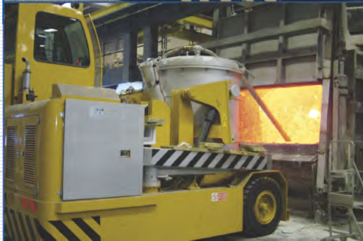
Veicolo per il trasporto ed il prelievo del metallo durante l'operazione di prelievo.
