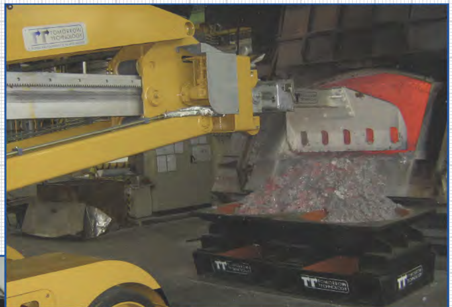
Operazione di scorifica e raccolta scoria di alluminio per pressatura.
