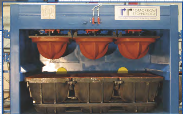
Pressa per il recupero dell'alluminio dalla scoria con capacità 2,6 tonnellate.
