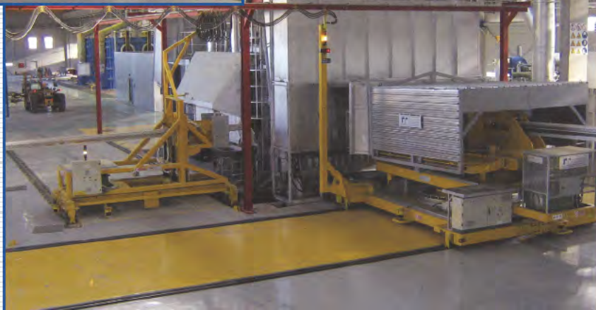
Caricatrice automatica in operazione e sistema di scorifica automatico su porta laterale.
