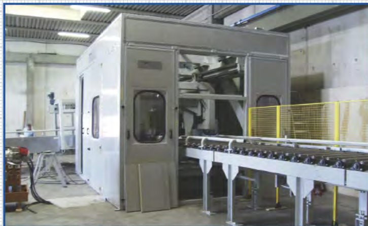
Particolare cabina sistema formazione slot.
