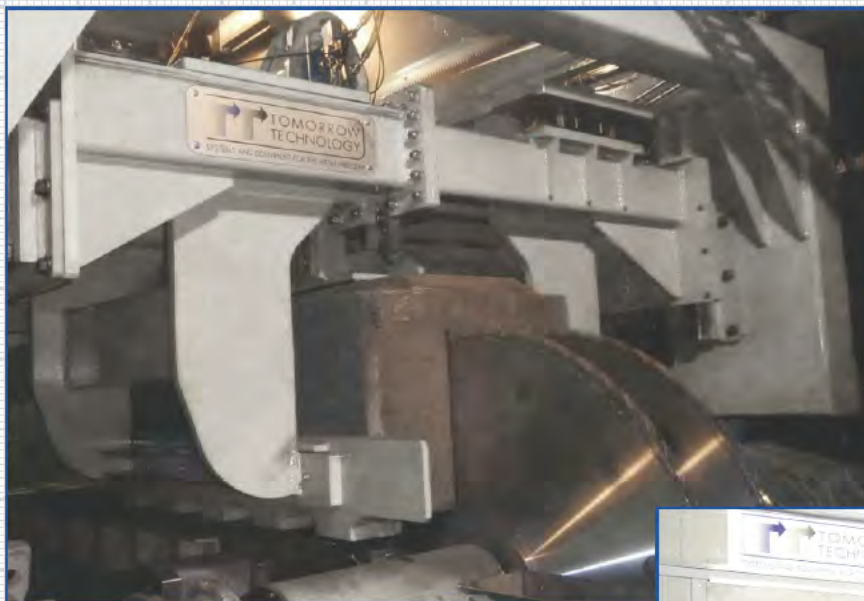
Sistema per formazione slot su anodi di diverse dimensioni.
