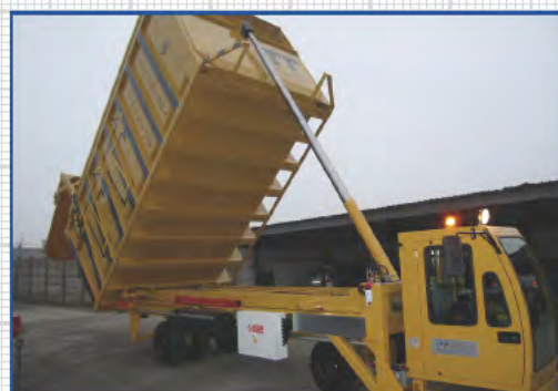
Veicolo Speciale per trasporto e movimentazione rottame di alluminio con capacità netta fino a 50 m3.
