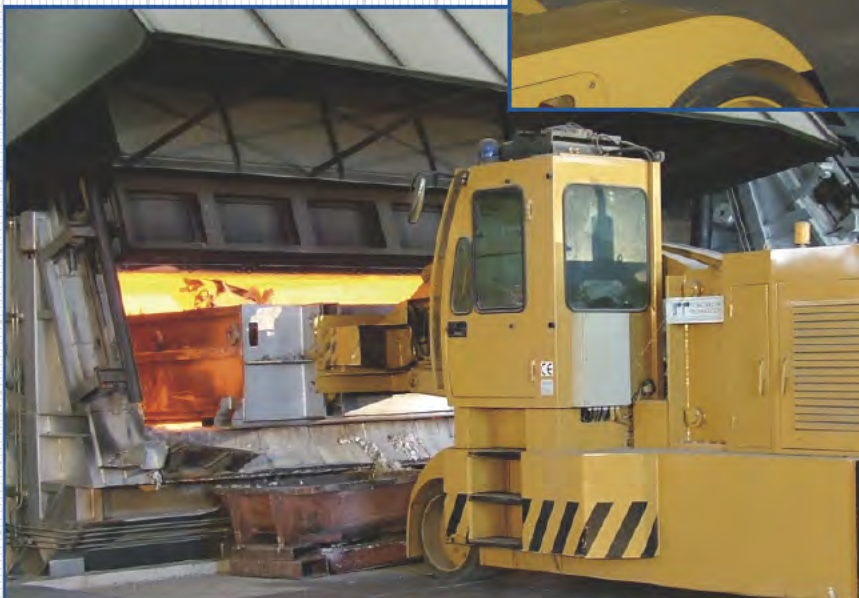
Veicolo Multifunzione durante un'operazione di carico con cassone da 6 ton. di capacità netta.
