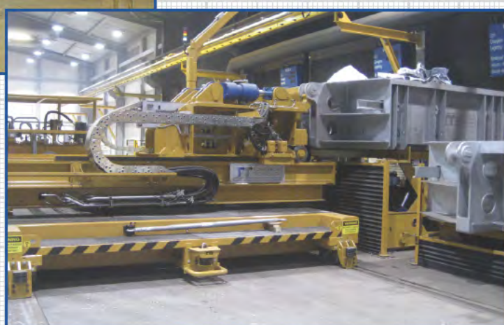
Caricatrice automatica da 10 ton per forni fusori.
