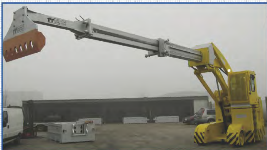
Veicolo Multifunzione con sollevamento telescopico per scorifica su forni alti oltre 3 metri.
