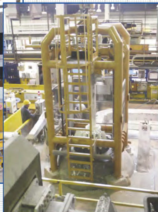
Sistemi automatici di scorifica e pulizia di forni fusori. Automatic skimming and cleaning equipment for melting furnaces
