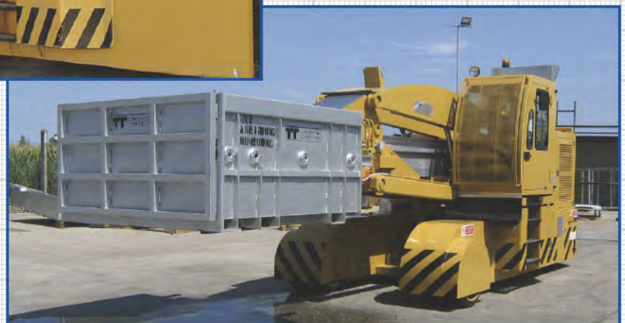
Veicolo Multifunzione con cassone di capacità netta 8 ton
