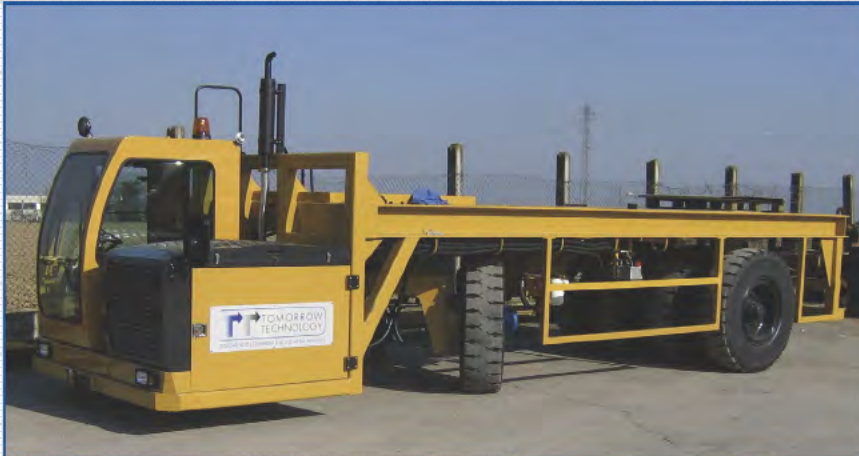
Veicolo Speciale per trasporto coil fino a 50 ton capacità netta.
