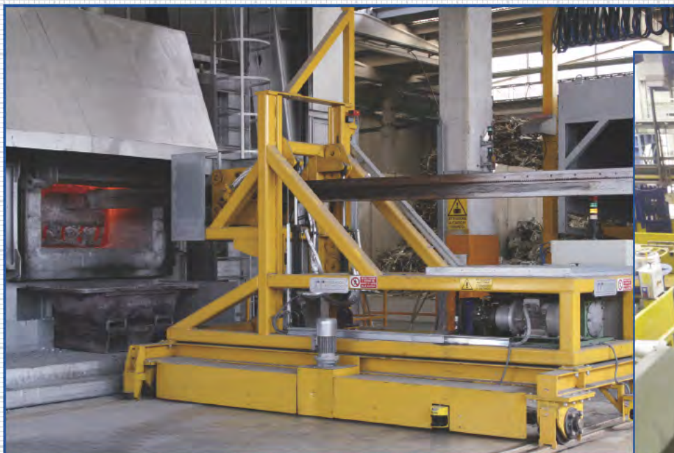
Sistemi automatici di scorifica e pulizia di forni fusori. Automatic skimming and cleaning equipment for melting furnaces
