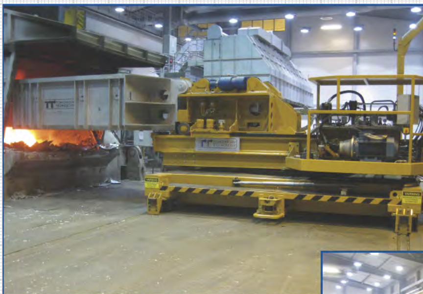
Caricatrice automatica da 10 ton per forni fusori.
